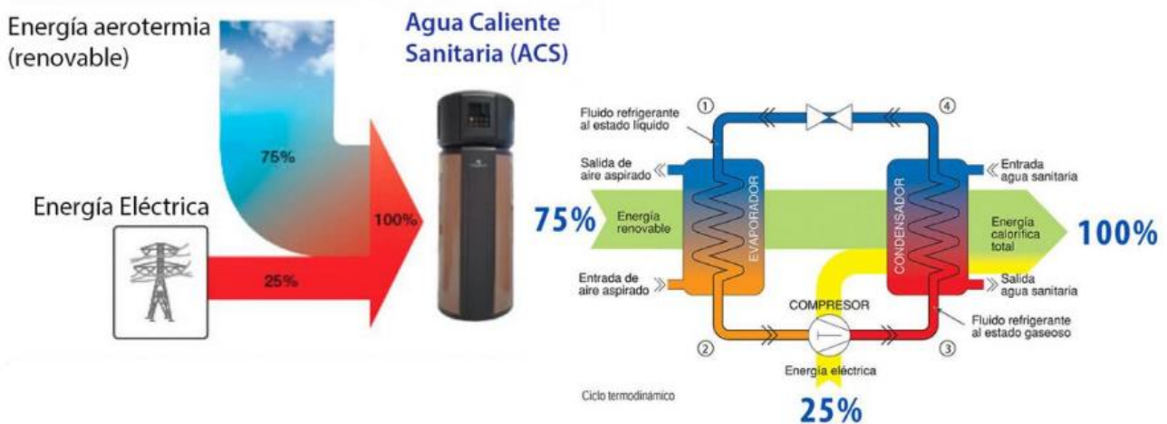
Ciclo termodinámico de una bomba de calor ACS. Imagen de DKclima.
